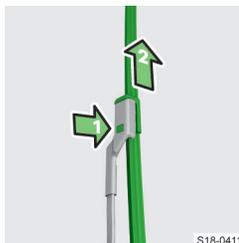
› Нажмите фиксатор и снимите щётку стеклоочистителя.
