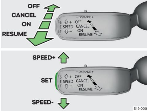
**ON** Активация адаптивного круиз-контроля (условие для последующей активации ограничителя) Для активации ограничителя скорости нажмите клавишу на многофункциональном рулевом колесе и выберите в комбинации приборов пункт *Огр. скор.*
