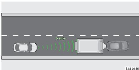
АСС распознает узкое транспортное средство или транспортное средство, движущееся со сдвигом, только когда оно попадет в область контроля радарного датчика.
