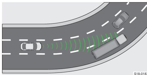
При движении на повороте в область контроля может попасть автомобиль на соседней полосе. Ваш автомобиль будет регулироваться в соответствии с этим автомобилем.
