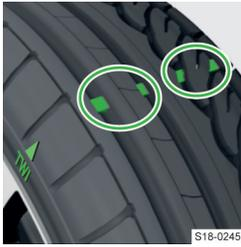
На основании протектора шин имеются индикаторы износа, которые показывают минимально допустимую высоту рисунка протектора.
