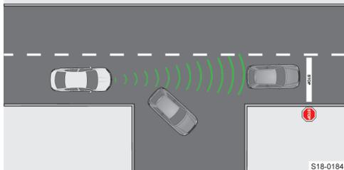
Если следующий впереди автомобиль сворачивает, а за ним появляется неподвижный автомобиль, адаптивный круиз-контроль не в состоянии среагировать на этот неподвижный автомобиль.
