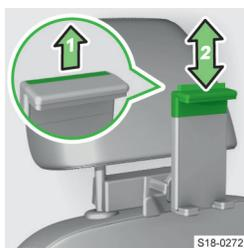
› Вытяните фиксатор и сдвиньте верхнюю часть держателя в нужное положение.
