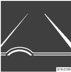
Выделена линия разметки справа: система выполняет подруливание при приближении к ограничительной линии разметки справа.
