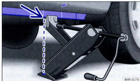
Илл. 138 Положение домкрата при замене левого заднего колеса.
