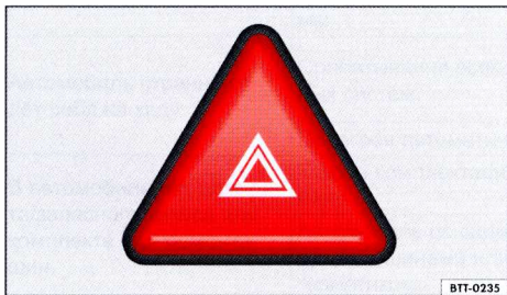
Илл. 122 В центре передней панели: выключатель аварийной световой сигнализации.
