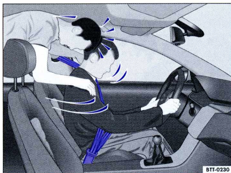
Илл. 41 Непристёгнутого заднего пассажира выбрасывает вперёд, на пристёгнутого водителя.
