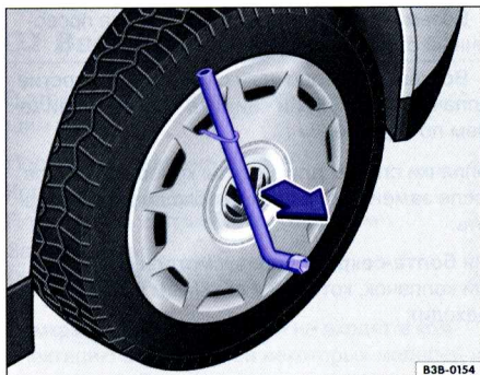
Илл. 132 Снятие вставного сплошного колпака.
