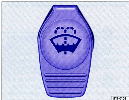
Илл. 64 Крышка бачка стеклоомывателя в моторном отсеке.
