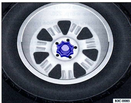
Илл. 118 В багажном отсеке: барашек крепления запасного колеса.
