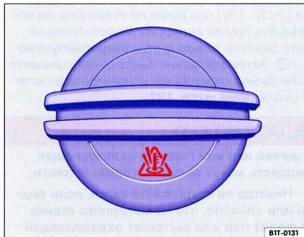
Илл. 110 В моторном отсеке: крышка расширительного бачка системы охлаждения.
