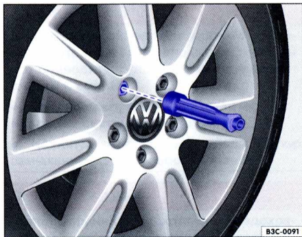
Илл. 139 Замена колеса: выворачивание колёсных болтов ручкой отвёртки.
