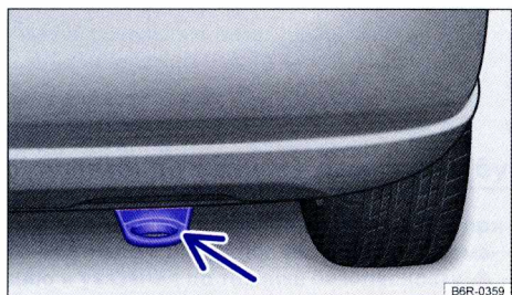
Илл. 157 В заднем бампере справа: несъемная буксирная проушина.
