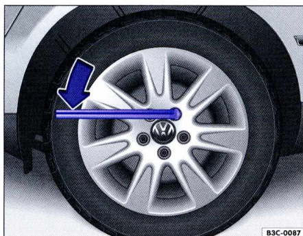
Илл. 135 Замена колеса: ослабление колёсных болтов.
