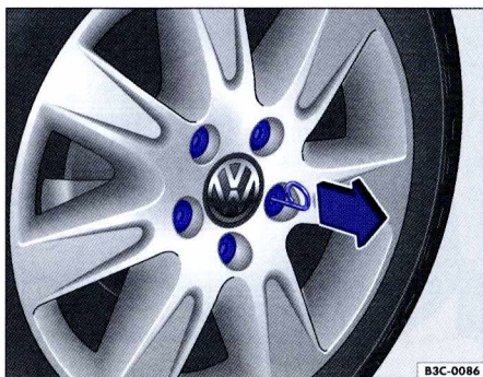
Илл. 134 Снятие колпачков колёсных болтов.
