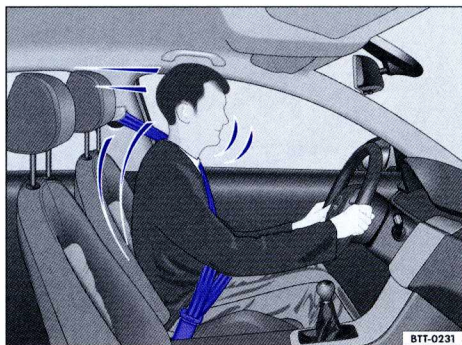
Илл. 42 При резком торможении пристёгнутого водителя удерживает ремень.
