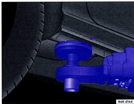
Илл. 121 Задние точки установки домкрата или подъёмника.
