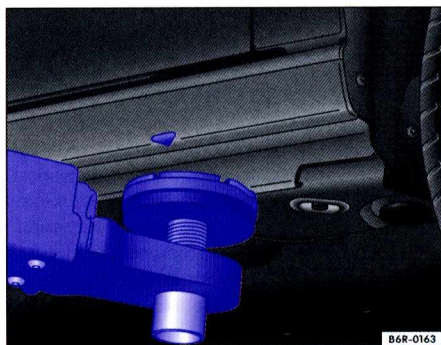
Илл. 120 Передние точки установки домкрата или подъёмника.
